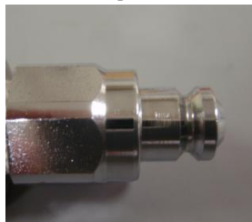
事故例1 【スリムプラグ+ガス機器用ソケット】
