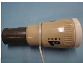
事故例1 【スリムプラグ+ガス機器用ソケット】
